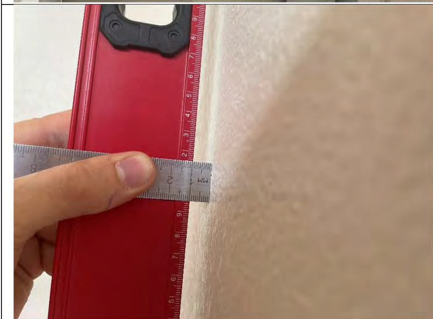
Фото №9. Измерение уровня стен в кухне-гостиной.
