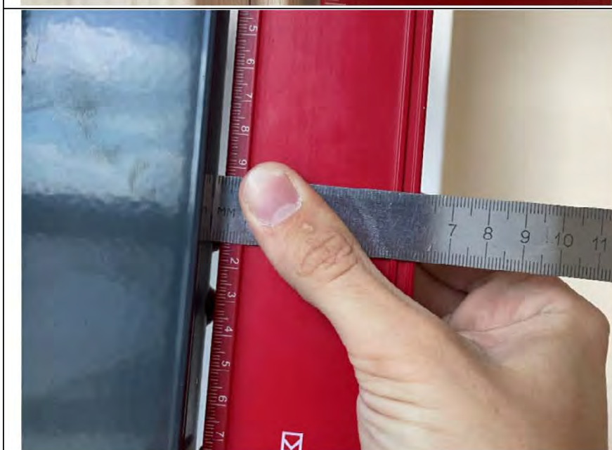
Фото №14. Измерение отклонения металлического оконного блока в спальне-гостиной по уровню вертикальности.
